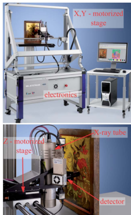
Figura 9: Set-up do Bruker M6 Jetstream, exemplo de MA-XRF
